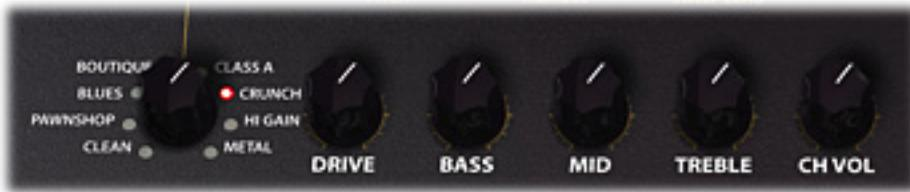
アンプ・モデル・セレクト・ノブと5個のアンプ・トーン・ノブ
