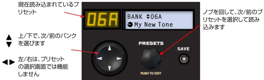
黄色のLEDインジケータとLCD画面の最上段で、現在のプリセット・アドレスを示します。◆ナビ・ディスク機能を使用して、バンクを1つずつ表示させながらプリセットに目を通します。
