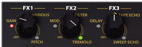
**FX1、FX2 & FX3**ノブはその巧妙なデザインから、「スマートFX」コントロールと呼ばれています。これらの3つのノブのいずれかを回すだけで、現在割り当てられているエフェクト・モデルの1つと、便利な構成済みのセッティングを素早く読み込むことができます。FXノブを最低値まで反時計方向に回すと、エフェクトは無効になります。
